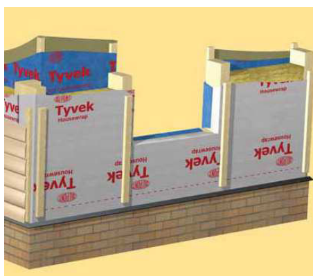
Рисунок П.3 – Монтаж контробрезетки по мембране Tyvek®
