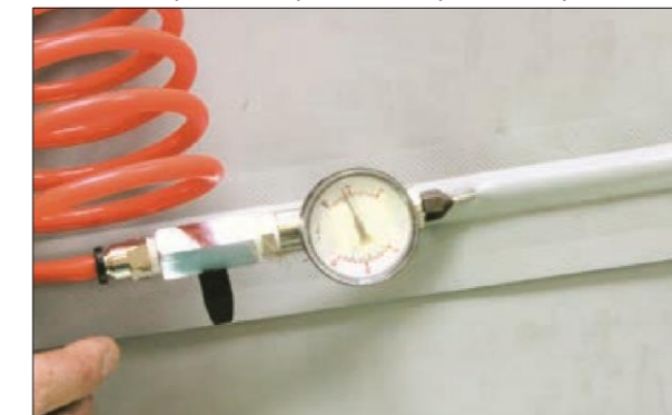
Рис. 5.2.13 Проверка герметичности с использованием сквозного канала
