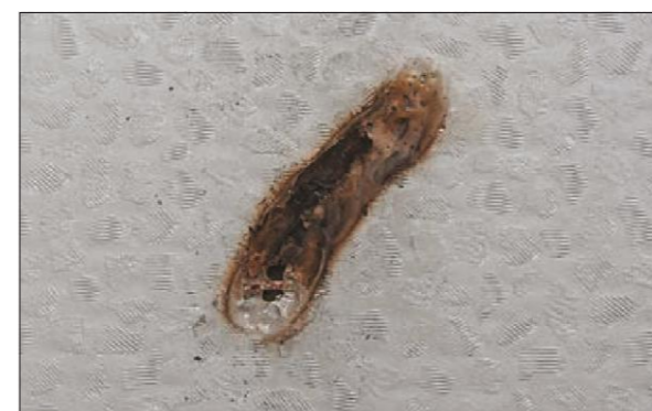
4.3.5 Повреждение на образце мембраны после испытания
