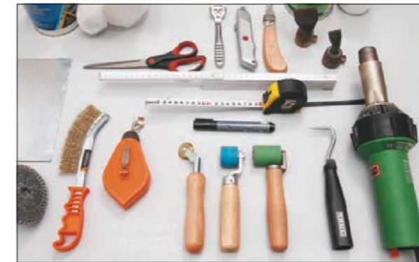
Рис. 5.1.1 Комплект оборудования для производства работ по укладке мембран
