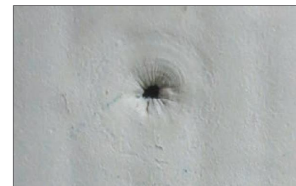
4.3.5 Повреждение на образце мембраны после испытания
