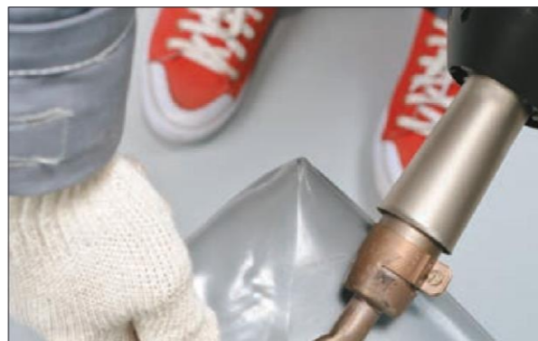
20. Выверните деталь наизнанку и проварите шов с внутренней стороны. Проверьте качество
