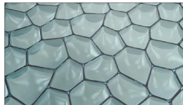
Рис. 4.4.1 Ячеистая структура PIR
