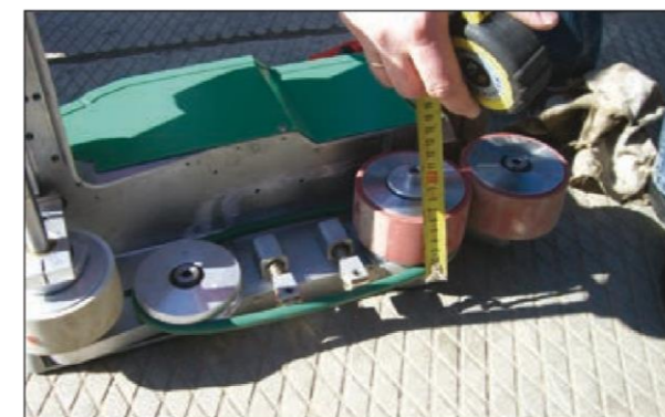
Рис. 3.5.5 Ширина рабочей поверхности Leister Varimat, равная 60 мм
